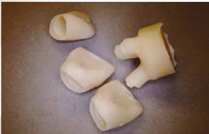
Abb. 9 und 10 Die überpressten Aluminiumoxidkäppchen direkt nach dem Abtrennen. Abbildung 10 zeigt die bereits ausgearbeitete Krone für den Lateralen
