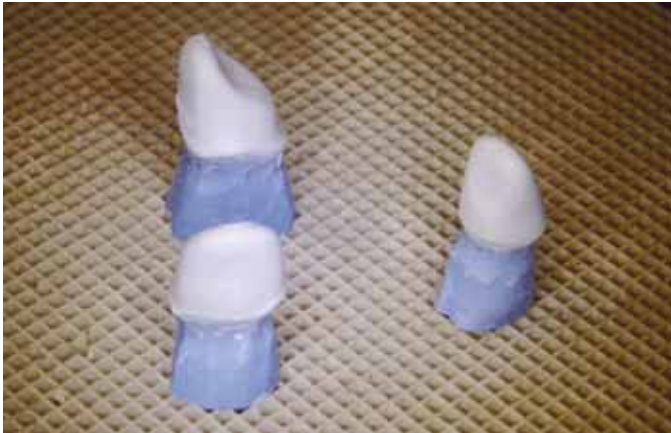
Abb. 6 Hier sind die elektro- phoretisch hergestellten Gerüste auf dem Brenn- träger, vor dem Sinte- rungsvorgang zu sehen
